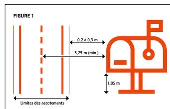
Le devant de la boîte doit être placé à une distance minimale de 5,25 m du centre de la chaussée et de 0,2 à 0,3 m de la limite extérieure de l'accotement, comme l'illustre la figure 1. Le bas de l'ouverture doit se situer de 1,05 à 1,15 m au-dessus du sol, comme
